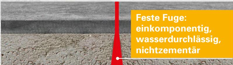
Die abstandhalterlosen PUREA-Platten lassen einen gleichmäßig verteilten, homogenen Fugeneintrag zu. Aufgrund der spezifischen Ausformung der Trägerplatte wird die Fuge nach unten breiter und stabiler.
