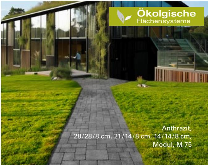
Das AMALFI AQUA Modul kann durch Verwendung eines drainagefähigen Fugenmaterials „Basalt 1–3 mm“ sowie eines Pflasterbettungsmaterials „Basalt 2–5 mm“ und einem drainagefähigen Unterbau ökologisch entsiegelt werden.
