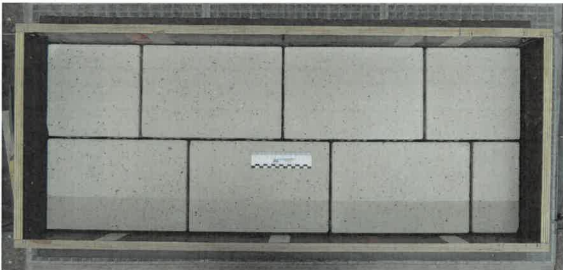
Bild 1: Verlegefläche vor der Fugenverfüllung
