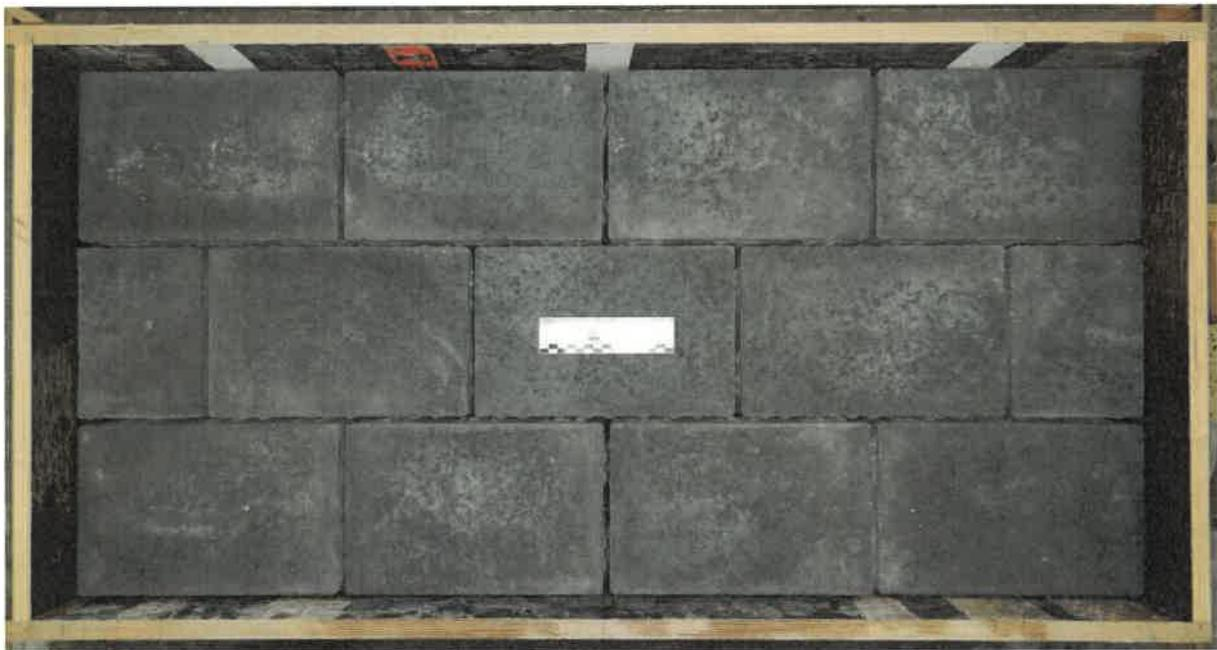
Es ist ausschließlich die Versickerungsleistung durch die im beschriebenen Verlegemuster verlegten Betonpflastersteine einschließlich der Fugenverfüllung und der Pflasterbettung zu ermitteln. Ein Einfluss der weiteren Schichten des Ober- und Unterbaus ist nicht Gegenstand der Untersuchungen.
