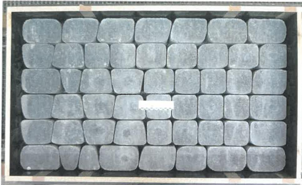
Es ist ausschließlich die Versickerungsleistung durch die im AG-seitig vorgegebenen Verlegemuster verlegten Betonpflastersteine (Reihenverband in der Herstellungslagenformation) einschließlich der Fugenverfüllung und der Pflasterbettung zu ermitteln. Ein Einfluss der weiteren Schichten des Ober- und Unterbaus ist nicht Gegenstand der Untersuchungen.
