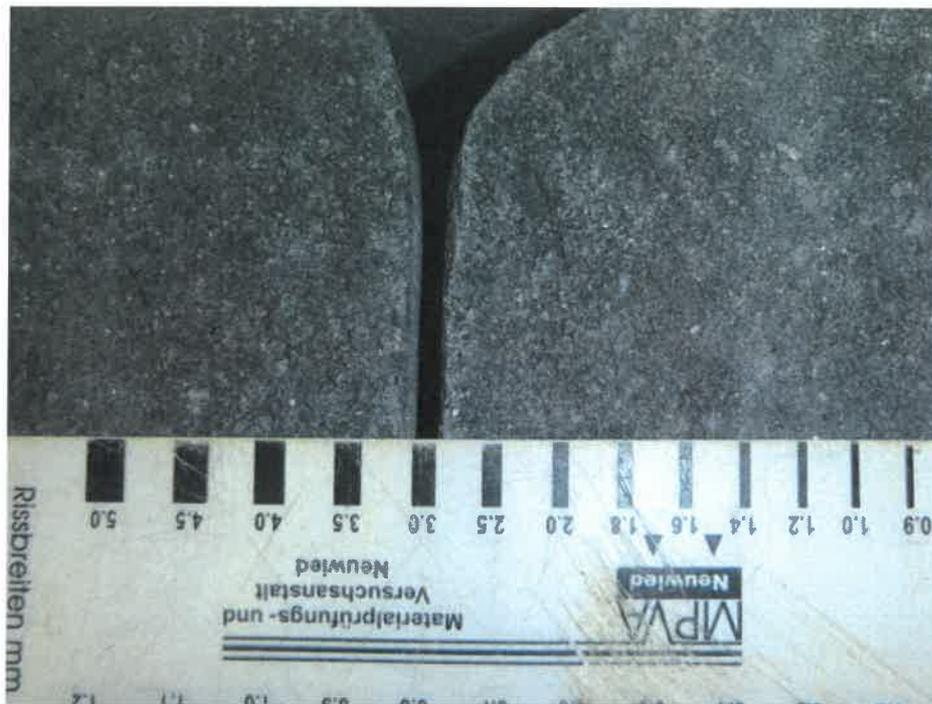
**Bild 4: Resultierende Fugenbreite mit Fugenfüllung**
