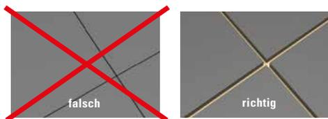
Die Platten sind mit gleichmäßigen Fugen (Breite 3–5 mm) zu verlegen. Verwenden Sie z. B. Fugenkreuze für einen gleichmäßigen Fugenverlauf, ein Verschieben der Platten wird verhindert. Bei fugenloser Verlegung (Pressfuge) können die Plattenkanten schon bei der Verlegung beschädigt werden.
